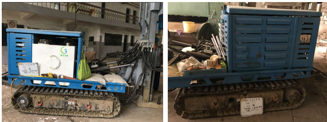
图 4.4.1.1-1 目标地块调查钻探采样过程
